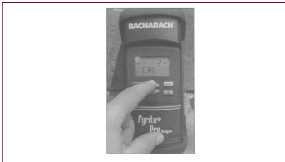
شکل ۸-۱: کالیبراسیون یک دستگاه قرائت مستقیم نوعی
